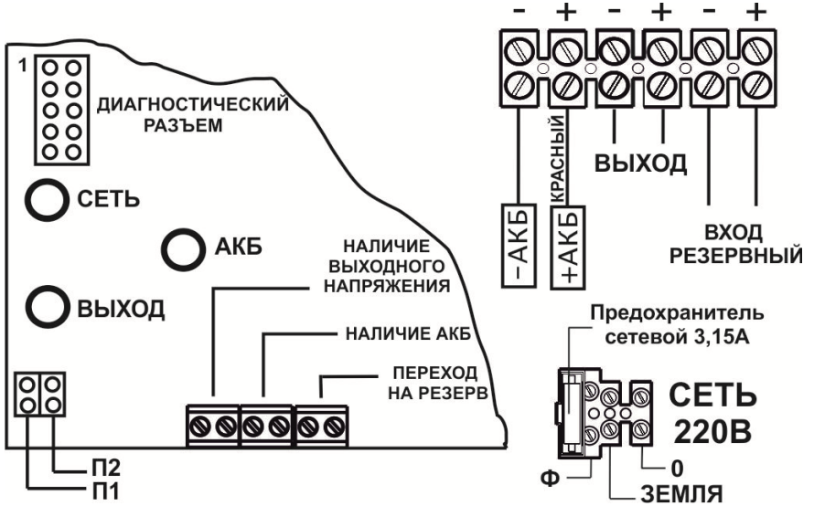
Рисунок 1. Вид источника с открытой крышкой (схема подключения)
