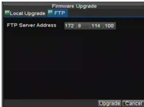
Рис. 12. Обновление устройства через FTP сервер
