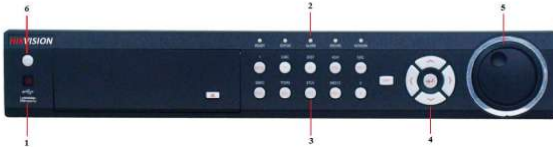
Рис. 3. Передняя панель цифрового регистратора
