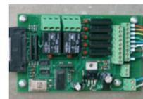
Электроника турникета защищена от короткого замыкания, перенапряжения и инверсии полярности.
