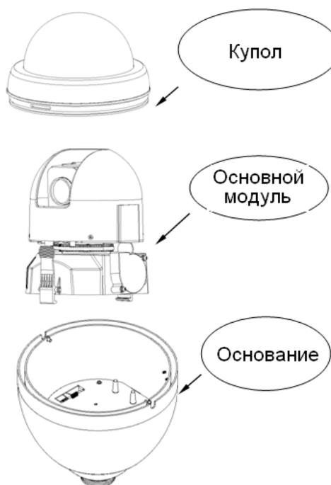
Рис. 1.2-2 Внешний вид элементов камеры
