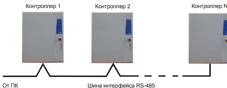
а). Соединение контроллеров по топологии «Шина».
