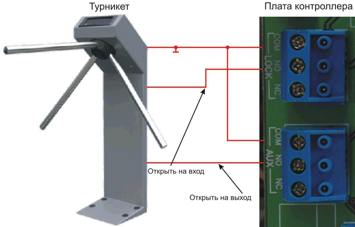
Рисунок 14. Подключение контроллера к турникуту.
