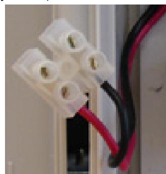
Рисунок 12. Кабель для подключения замка к источнику питания.
