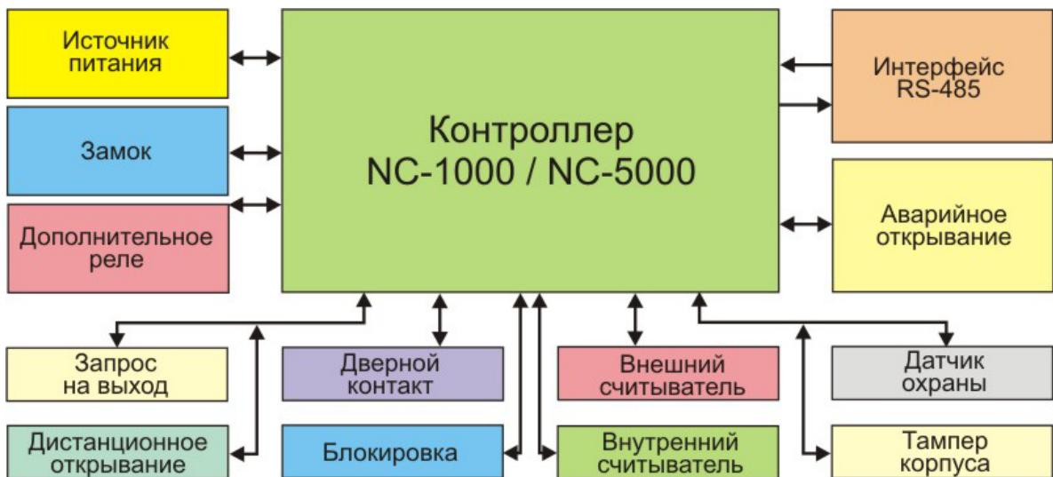
*Рисунок 7. Оборудование, подключаемое к контроллерам NC-1000 / NC-5000.*
