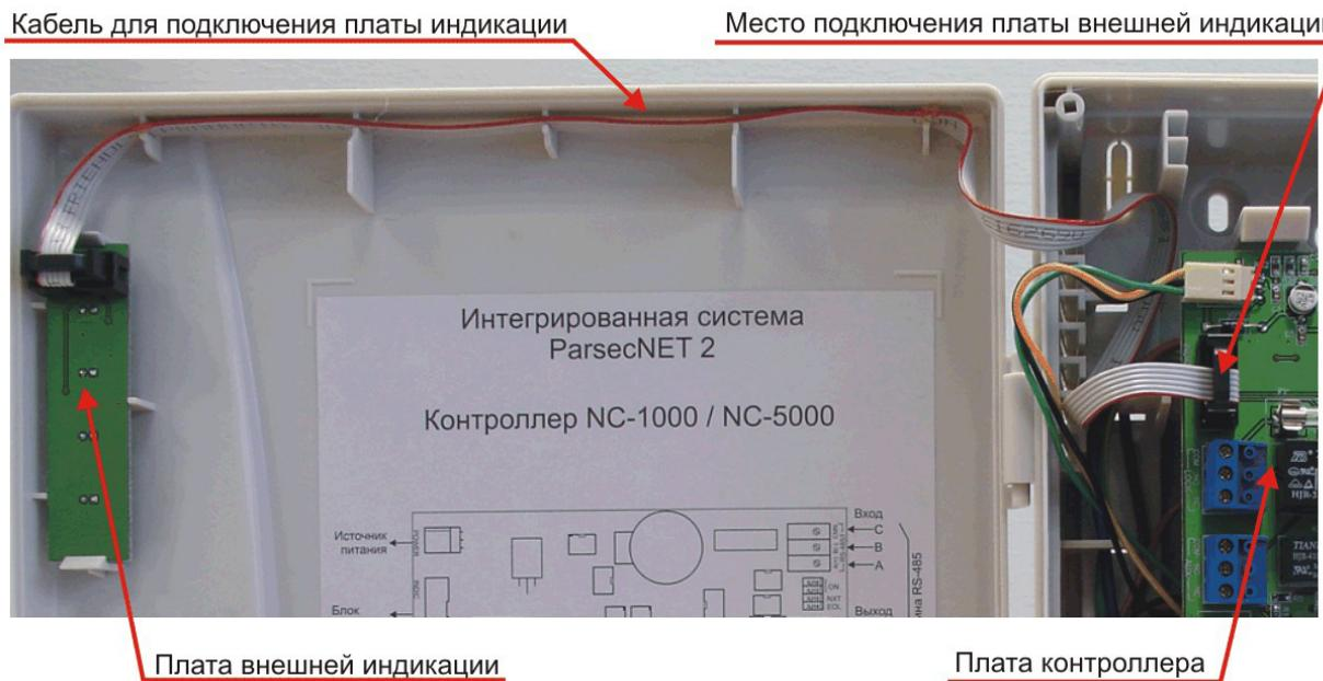
Рисунок 21. Схема подключения платы внешней индикации.
