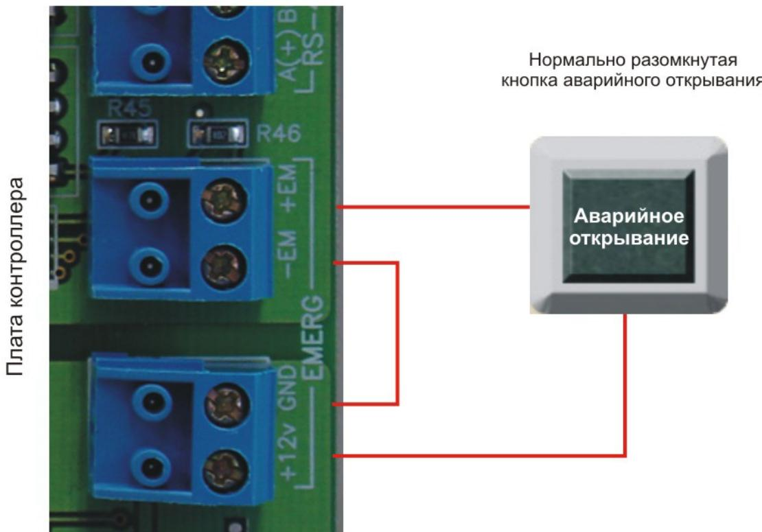
Рисунок 18. Подключение аварийной кнопки к одному контроллеру.
