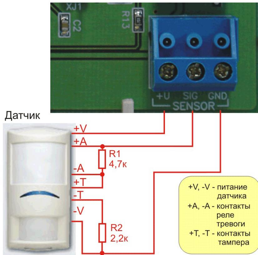
Рисунок 15а. Подключение охранного датчика с контролем подводящих проводов.
