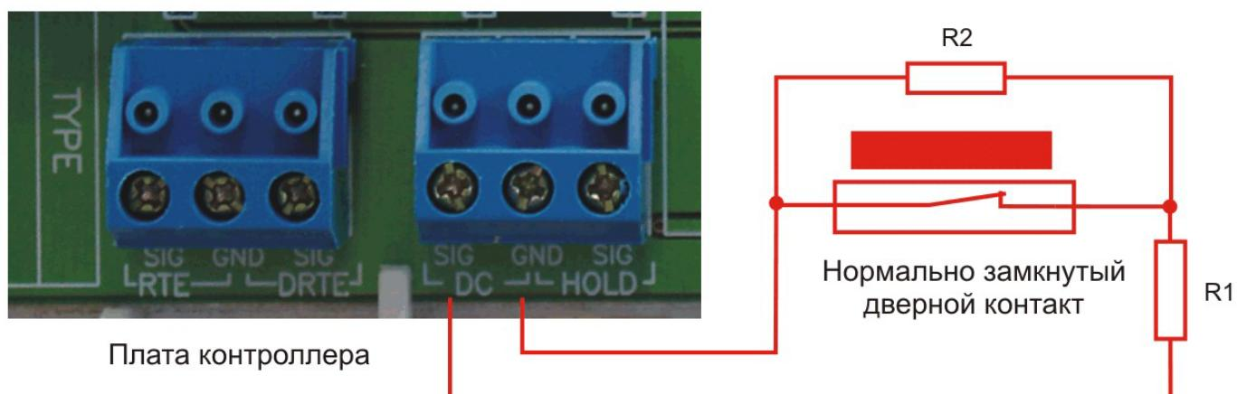
Рисунок 10б. Подключение DC с контролем подводящих проводов.
