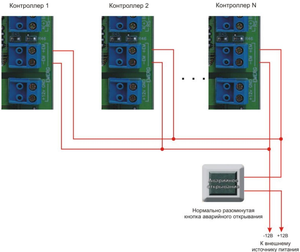
*Рисунок 19. Подключение одной кнопки к нескольким контроллерам.*
