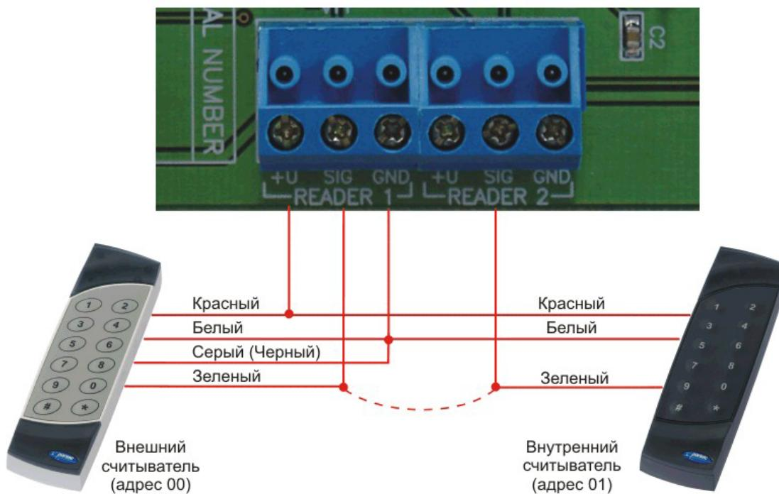
Рисунок 8а. Подключение считывателей серии NR-xxx к контроллерам NC-1000/NC-5000.
