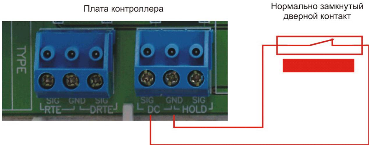
Рисунок 10а. Подключение DC без контроля подводящих проводов.
