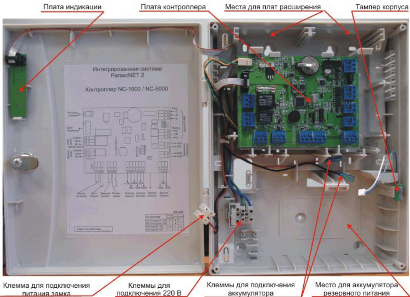
Рисунок 1. Контроллер NC-1000 / NC-5000 в корпусе.
