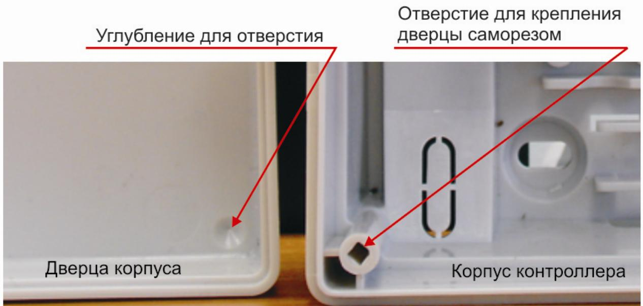
Рисунок 3. Схема «жесткого» крепления дверцы к корпусу контроллера.
