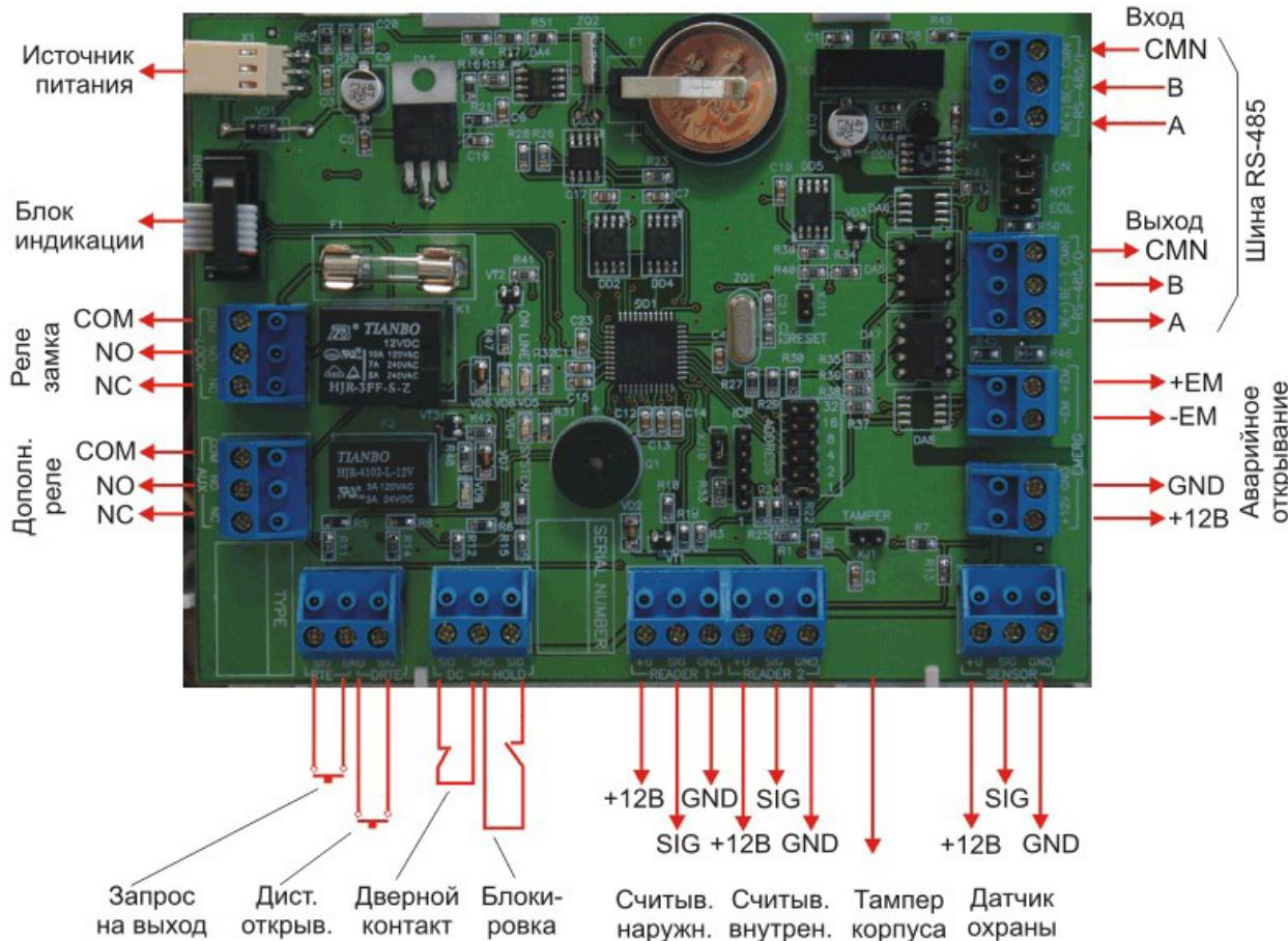
Рисунок 6. Печатная плата контроллеров NC-1000 / NC-5000.
