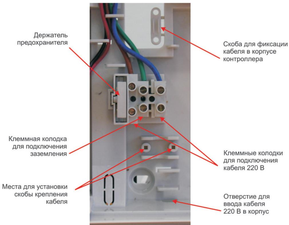
*Рисунок 5. Подключение контроллера к сети 220 В.*
