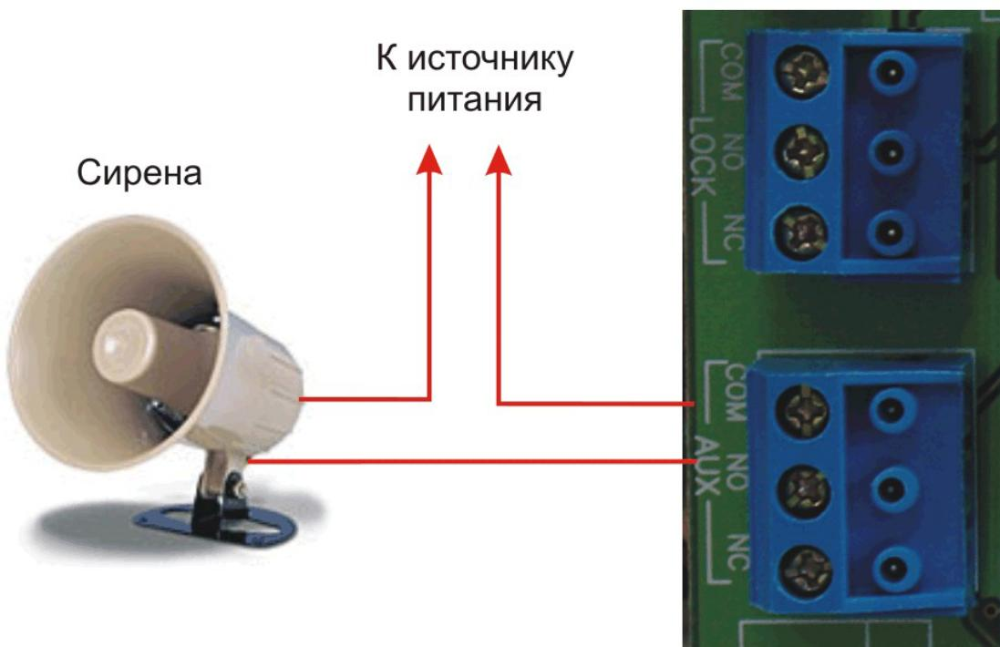
Рисунок 16. Подключение к дополнительному реле.
