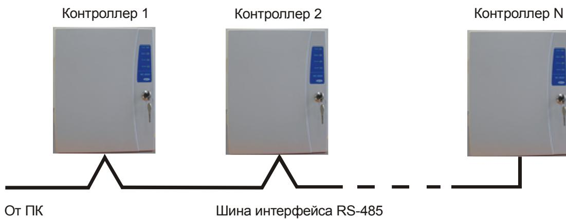
a). Соединение контроллеров по топологии «Шина».
