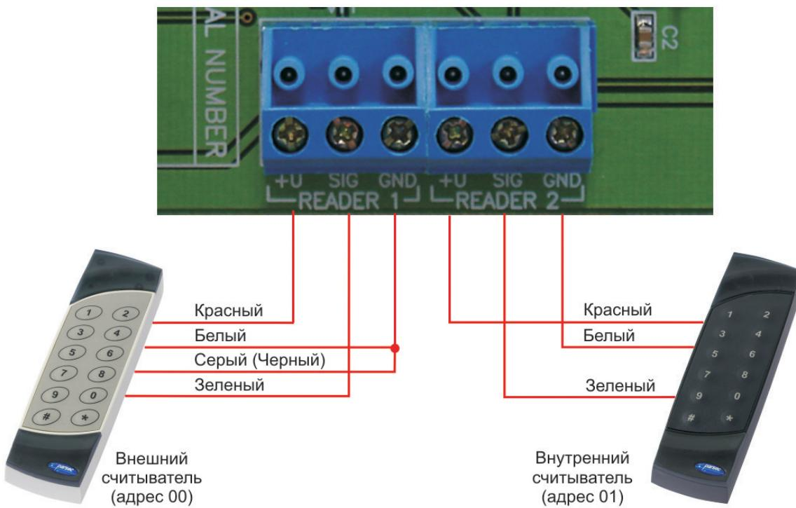
*Рисунок 8б. Подключение считывателей серии NR-xxx к контроллерам NC-1000/NC-5000.*
