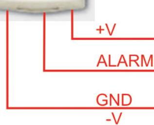
Рисунок 15б. Подключение охранного датчика без контроля подводящих проводов.
