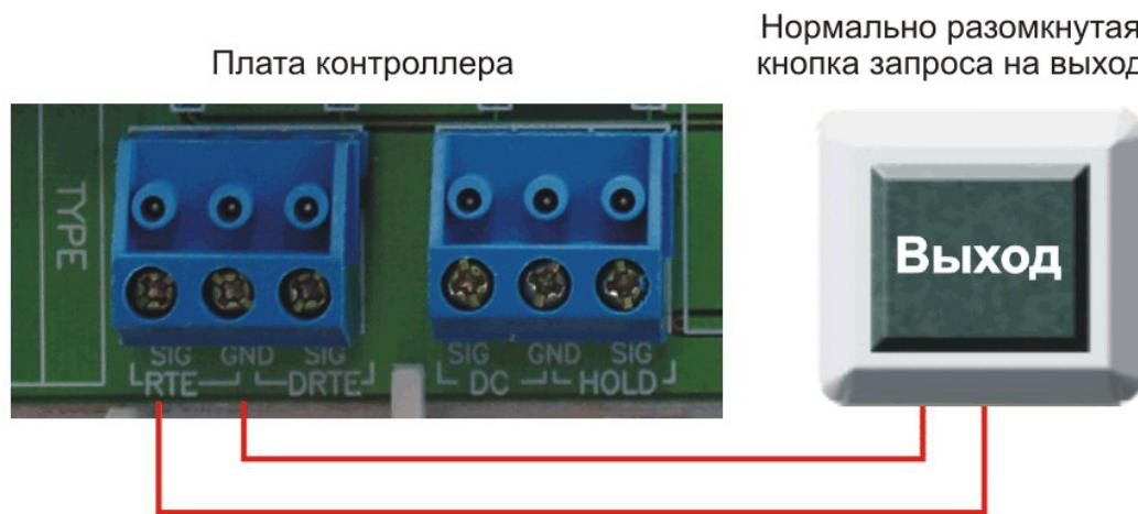
Рисунок 9. Схема подключения кнопки запроса на выход.
