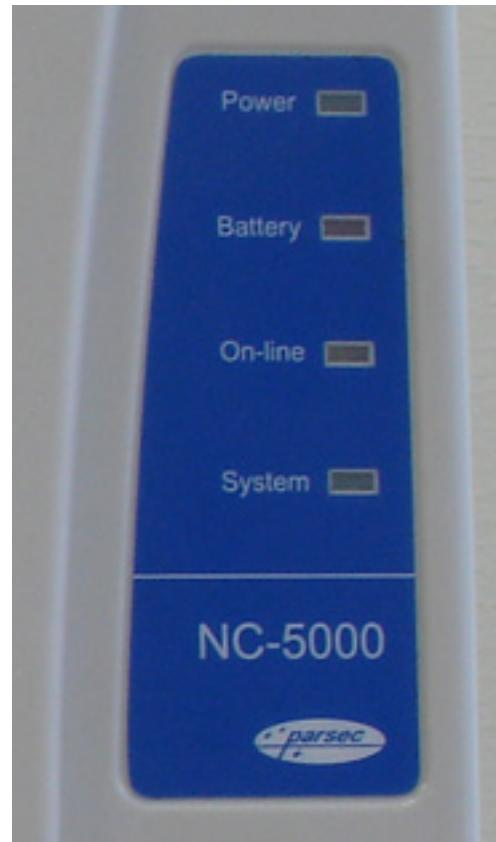
*Рисунок 20. Внешняя индикация состояний контроллера.*
